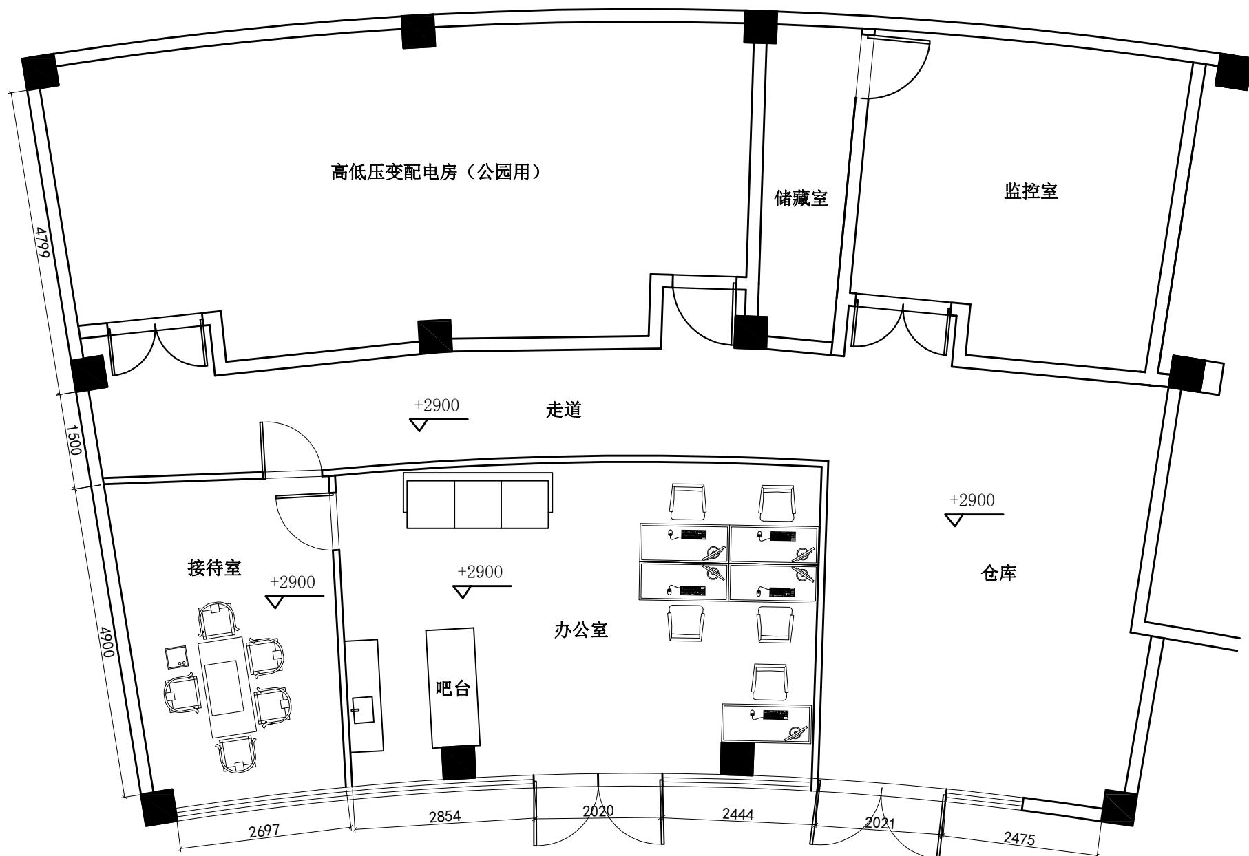
原始平面图 SCALE1:40
